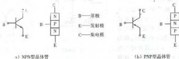
图 7.4-7 晶体管结构示意图及电路符号
